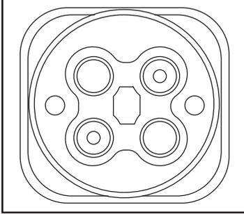
2. Para operar la linterna de celdas de 4 AA llena los cuatro posiciones observando la polaridad de la batería correcta.
