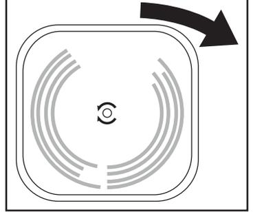
3. Reemplaza la tapa de la batería y giro para cerrar contador de tapa en sentido horario.
