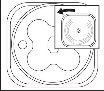
1. Gira la linterna y retire la tapa de la batería girando el contador de tapa en sentido horario.
